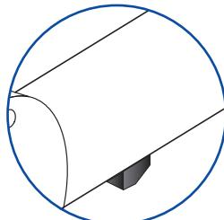
Tlumič je integrován přímo ve vodící tyči
