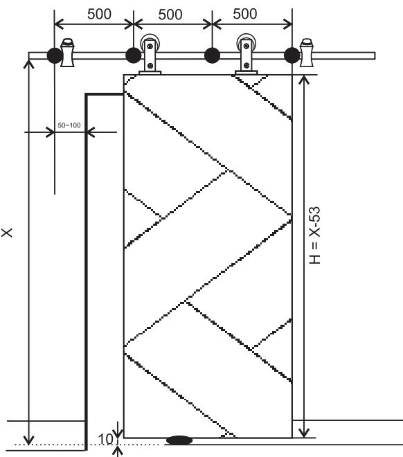
Designové kování pro dřevěné posuvné interiérové dveře o maximální hmotnosti 90 kg.
